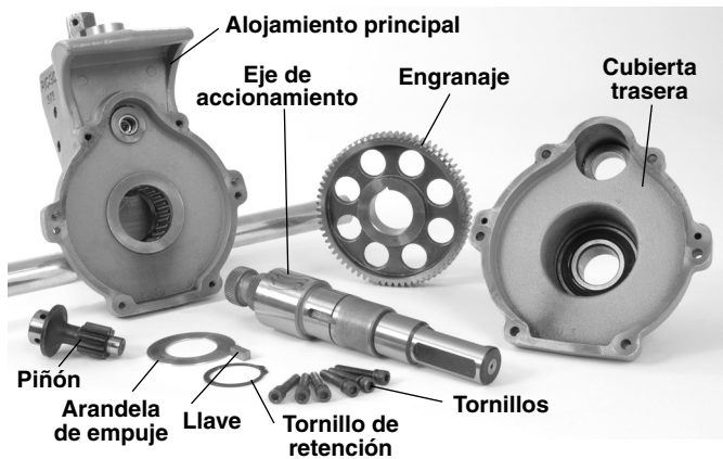
Figura 3 – Piezas y partes de la Ranuradora a Rodillos No. 975
